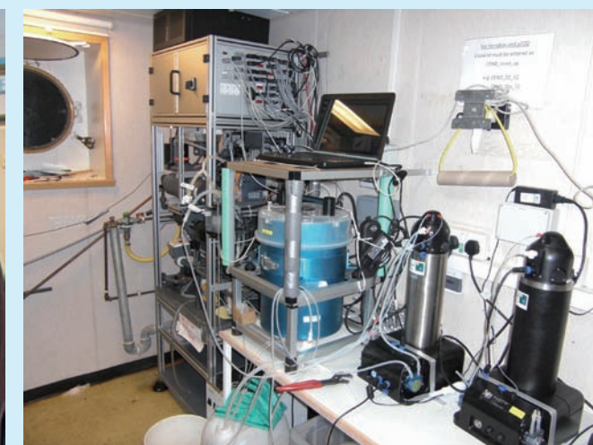
建立在Ferry box上的Cyto sense在线监测系统
